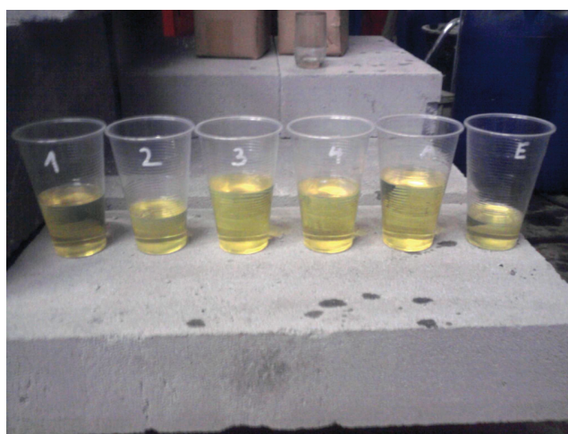
PŘÍKLAD MĚŘENÍ ÚNIKU PALIVA ZE VSTŘIKOVAČŮ (ÚNIK ZE VSTŘIKOVAČŮ Č.3 A Č.4)
