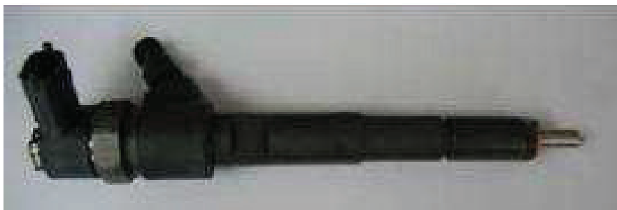
ELEKTRICKÝ VSTŘIKOVAČ BOSCH (VRATNÉ VEDENÍ PŘES CÍVKU DO SBĚRNÉ HADICE)
